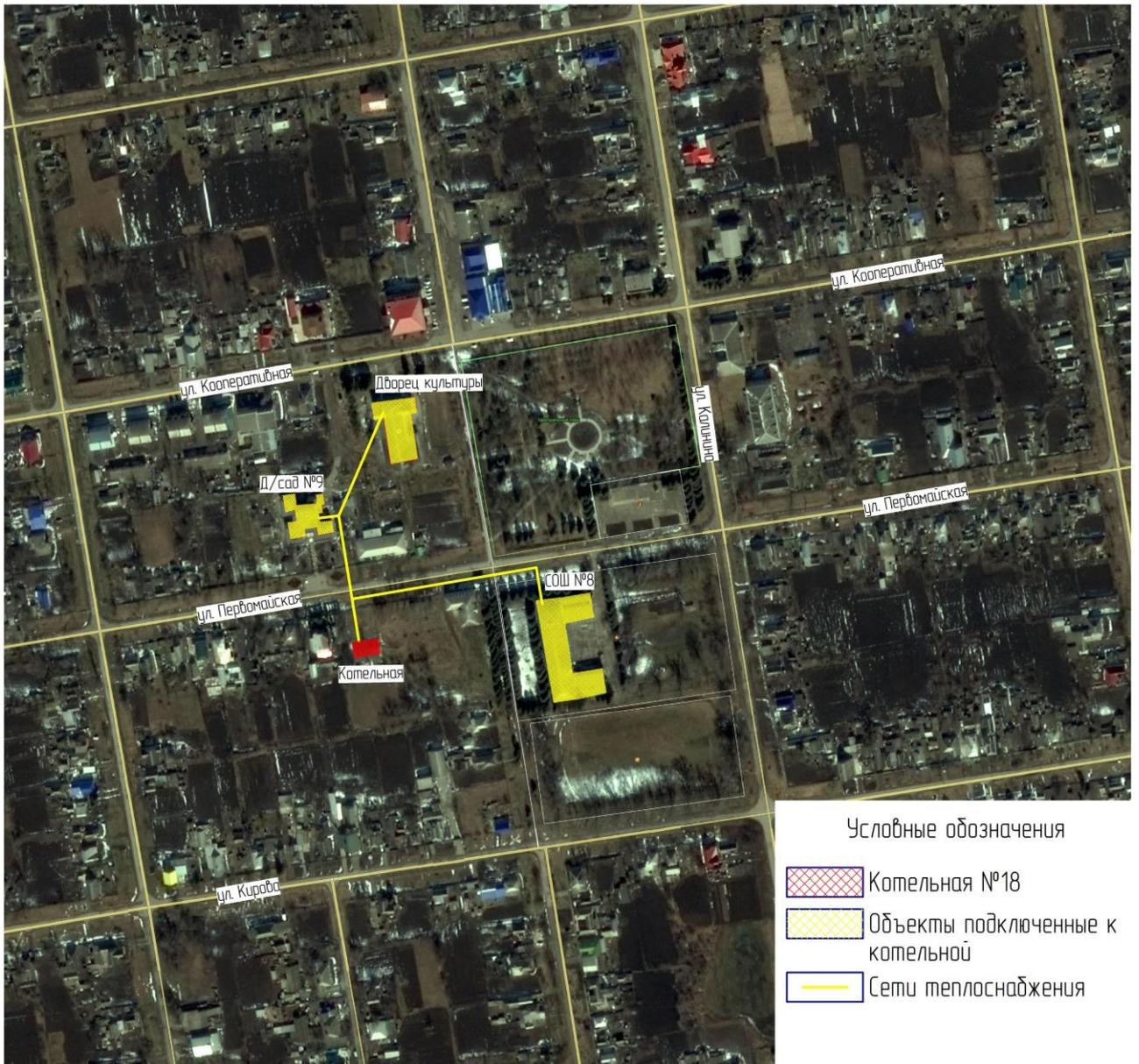
Рис. 1. Схема теплоснабжения Котельной №18 ст. Новопластуновская.
